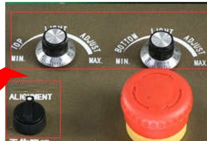
Molettes de réglage de l'intensité de la lumière LED des modules d'éclairage du haut et du bas de la caméra d'alignement
